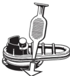
Estrarre il grande Anello di Tenuta del Fondo facendo leva con l'Utensile della Camera di Riempimento sull'apertura della scanalatura. Togliere l'Anello di Tenuta del Fondo piccolo.
