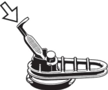
Presione hasta expulsar la Malla con la Herramienta de la Cámara de Relleno de arriba a abajo del fondo del Unidad de Enfriamiento.
