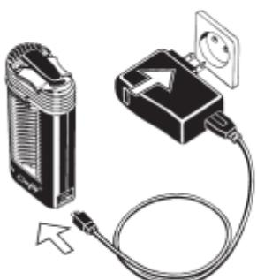
Cargue el Vaporizador con el Cargador USB.
