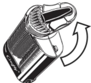
Schroef de Koeleenheid los van de Verdamper door hem 90° tegen de wijzers van de klok in te draaien.
