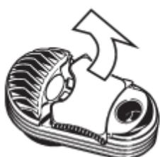
En caso de limpieza de la tapa de la Unidad de Enfriamiento en alcohol isopropílico, retire el cierre de la tapa levantando en un lateral.
