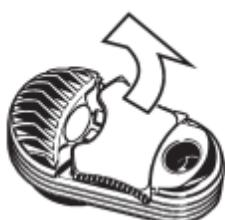
In caso di pulizia del coperchio dell'Unità di Raffreddamento nell'alcool isopropilico, smontare il chiavistello del coperchio sollevandolo da un lato.
