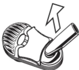
Extraiga la Boquilla moviéndola e inclinándola ligeramente de la tapa de la Unidad de Enfriamiento.
