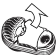
Pour nettoyer le couvercle de l'Unité de Refroidissement avec de l'alcool isopropylique, démonter le verrou de couvercle en le soulevant d'un côté.
