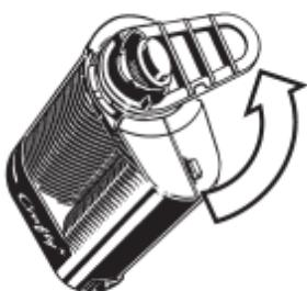
Démonter la base de l'Unité de Refroidissement du Vaporisateur en le dévissant de 90° dans le sens inverse des aiguilles d'une montre.
