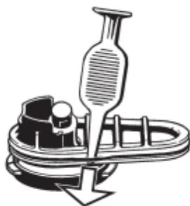
Großen Bodendichtring mit Füllkammerwerkzeug an der Aussparung in der Nut aushebeln.
