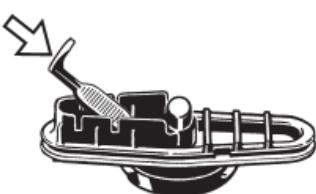
Sieb mit Füllkammerwerkzeug von oben nach unten aus Kühleinheitboden herausdrücken.
