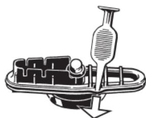
Haal de grote Bodemafdichtring met Vulkamerhulpmiddel uit de uitsparing in de groef.
