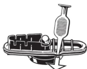
Großen Bodendichtring mit Füllkammerwerkzeug an der Aussparung in der Nut aushebeln.
