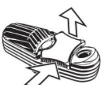
Bij het reinigen van Deksel Koeleenheid in Isopropylacohol, moet u de Dekselvergrendeling verwijderen. Druk eerst aan één kant op de Dekselvergrendeling en trek dan de andere kant omhoog.
