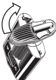
Enrosque la Unidad de Enfriamiento girándola 90° en sentido de las agujas del reloj sobre el Vaporizador.
