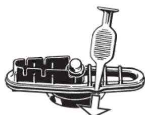
Levante el Anillo de Sellado de Fondo grande con la Herramienta del Depósito en la muesca de la ranura. Retire el pequeño Anillo de Sellado de Fondo.
