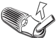
Trek het deksel van de Koeleenheid van de Verdampert.
