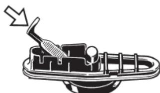
Presione hasta expulsar la Malla con el Herramienta del Depósito de arriba a abajo del suelo de la Unidad de Enfriamiento.
