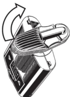
Kühleinheit durch eine 90° Drehung im Uhrzeigersinn anschrauben.
