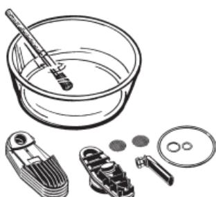
Immergere tutti i componenti dell'Unità di Raffreddamento in acqua di lavaggio calda. Alternativa: immergere tutti i componenti dell'Unità di Raffreddamento (eccetto il Chiavistello del Coperchio) nell'alcol isopropilico per 1/2 ora al massimo. Risciacquare tutti i componenti per almeno un minuto sotto l'acqua corrente. Lasciare asciugare completamente tutti i pezzi.
