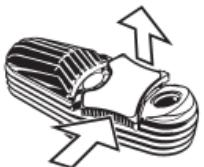
Pour nettoyer le couvercle de l'Unité de Refroidissement avec de l'alcool isopropylique, démonter le Verrou de Couvercle en le soulevant d'un côté. Pour commencer, appuyez sur le Verrou de Couvercle d'un côté et tirez-le vers le haut et vers le côté opposé.
