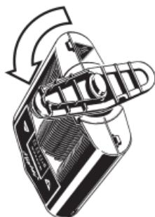
Desenrosque la Unidad de Enfriamiento del Vaporizador girando 90° en sentido contrario a las agujas del reloj.
