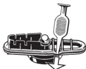
Estrarre il grande Anello di Tenuta del Fondo facendo leva con l'Utensile del Contenitore sull'apertura della scanalatura. Togliere l'Anello di Tenuta del Fondo piccolo.
