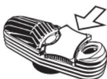
A continuación, deslice el cierre de la Tapa en el lado levantado en dirección al lado opuesto.
