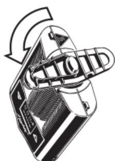
Kühleinheitboden durch eine 90° Drehung entgegen dem Uhrzeigersinn vom Verdampfer abschrauben.
