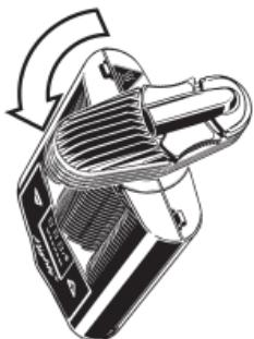
Démonter l'Unité de Refroidissement du Vaporisateur en la dévissant de 90° dans le sens inverse des aiguilles d'une montre.
