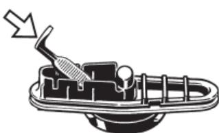
Druk de Zeef met Vulkamerhulpmiddel van boven naar beneden uit de bodem van de Koeleenheid.
