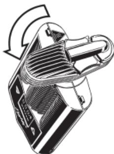
Svitare l'Unità di Raffreddamento dal Vaporizzatore compiendo una rotazione di 90° in senso antiorario.
