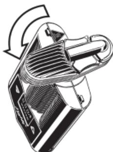
Schroef de Koeleenheid los van de Verdamper door hem 90° tegen de wijzers van de klok in te draaien.
