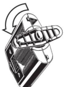
Démonter le fond de l'Unité de Refroidissement du Vaporisateur en le dévissant de 90° dans le sens inverse des aiguilles d'une montre.
