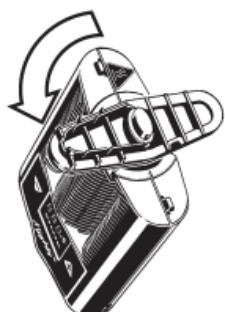
Schroef de bodem van de Koeleenheid los van de Verdamper door hem 90° tegen de wijzers van de klok in te draaien.
