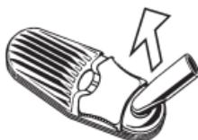
Extraiga la Boquilla moviéndola e inclinándola ligeramente de la tapa de la Unidad de Enfriamiento. Extraiga el Anillo de Sellado de Boquilla.
