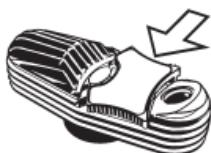
Anschließend den Deckelriegel an der hochgezogenen Seite in Richtung der gegenüberliegenden Seite schieben.
