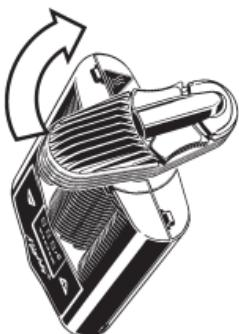
Visser l'Unité de Refroidissement sur le Vaporisateur en la tournant de 90° dans le sens des aiguilles d'une montre.
