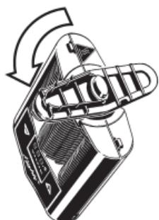
Svitare il fondo dell'Unità di Raffreddamento dal Vaporizzatore compiendo una rotazione di 90° in senso antiorario
