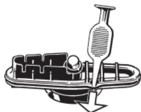
Dégager le grand Joint de Base sur l'évidement de rainure à l'aide de l'Outil de Chambre de Remplissage. Retirer le petit Joint de Base.
