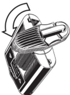
Enrosque la Unidad de Enfriamiento del Vaporizador girando 90° en sentido contrario a las agujas del reloj.
