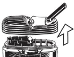
Tire de la tapa de la Unidad de Enfriamiento del Vaporizador.
