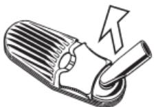
Démonter l'Embout du couvercle de l'Unité de Refroidissement en le tournant légèrement dans les deux sens. Retirer le Joint d'Embout.
