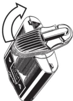
Avvitare l'Unità di Raffreddamento sul Vaporizzatore compiendo una rotazione di 90° in senso orario.
