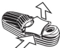
En caso de limpieza de la tapa de la Unidad de Enfriamiento en alcohol isopropílico, retire el cierre de la tapa levantando en un lateral. En primer lugar, presione el cierre de la Tapa en un lateral y levántelo en el lado opuesto.
